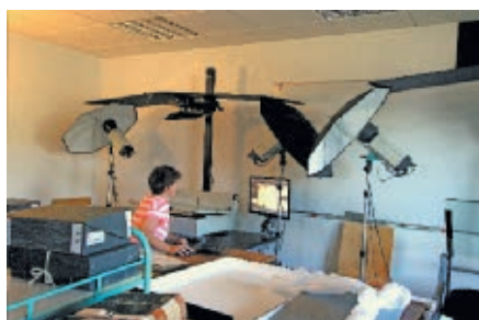
Une opératrice de l'entreprise partenaire travaille sur une table de prise de vue équipée du matériel photographique monté sur potence, relié aux systèmes informatiques pour le traitement et la sauvegarde des images.
